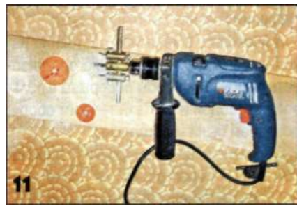
11 Ровные аккуратные отверстия в кафельной плитке под трубы и электрические розетки можно сверлить с помощью этого нехитрого приспособления.
