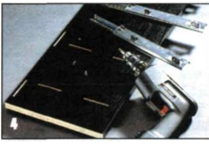
4 Прежде чем собрать корпус канторки, к боковым стенкам (N) крепят шурупами телескопические направляющие (по четыре направляющих на каждую стенку)
